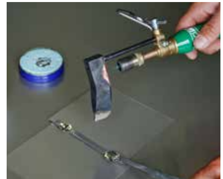
Das Lot anpressen bis die Verbindung hält und das Zinn ausgekühlt ist. Zur schnelleren Abkühlung den LötKolben anheben.
