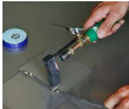
Zinn auf Heftpunkt übertragen und Naht zusammenpressen.
