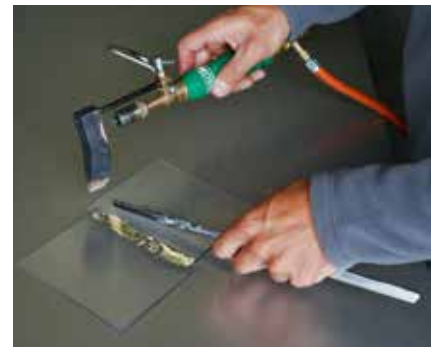
Ob die Naht abgekühlt ist erkennen sie an der angelaufenen Oberfläche.
