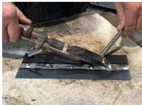
Lot schmelzen, auf Nahtstelle übertragen und mit gleichmäßiger Bewegung eine Naht ziehen.
