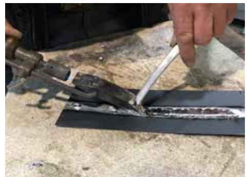
Wiederholen bis die Lötnaht fertiggestellt ist. Ob die Naht abgekühlt ist erkennen sie an der angelaufenen Oberfläche.
