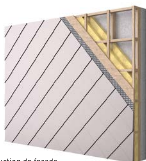
Construction de façade
